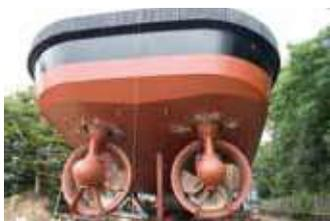
Doppelschraubenantrieb mit Mantelpropellern (Kort-Düsen)
