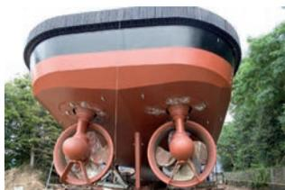
Doppelschraubenantrieb mit Mantelpropellern (Kort-Düsen)
