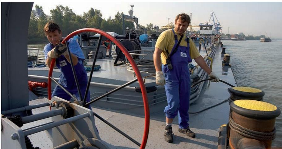
Matrosen bei der Verheftung eines Tankschubleichters
