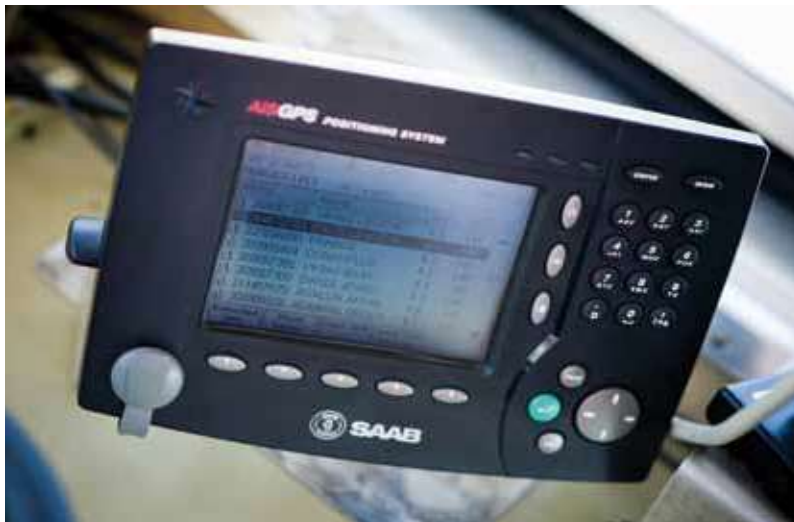
AIS-Transponder an Bord eines Binnenschiffes
