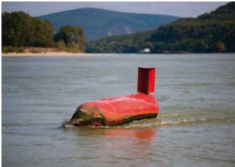
Roter Schwimmer mit zylinderförmigem Toppzeichen zur Bezeichnung des rechten Fahrrinnenrandes
